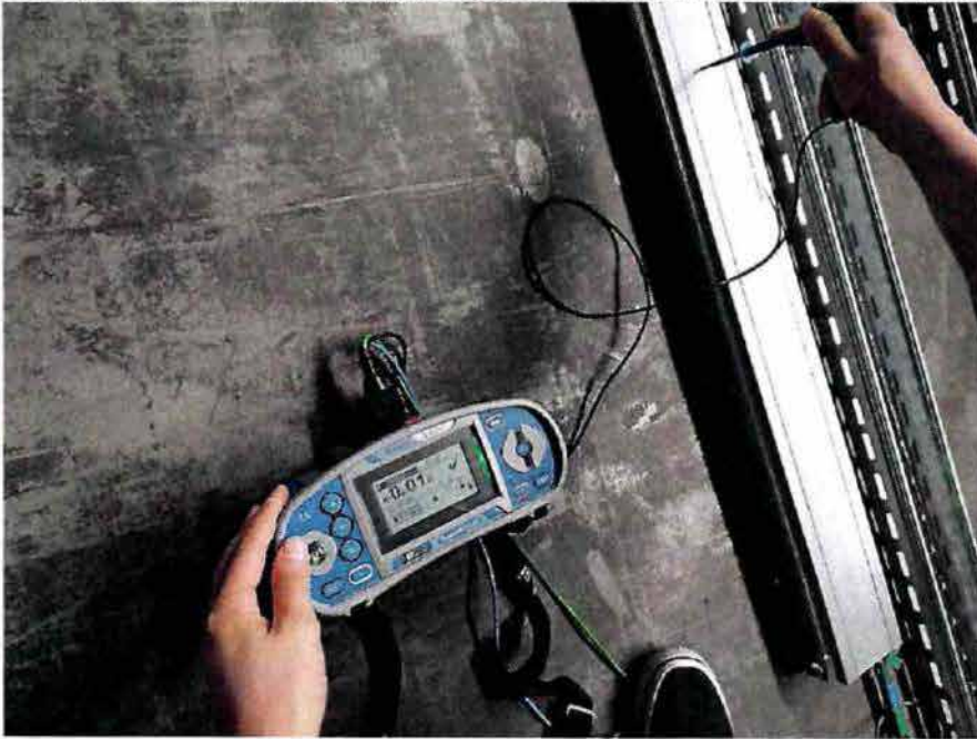
3. Соединение лотка ЛПМЗТ(М) с крышкой лотка КЛЗТ – значение замера 0,01
